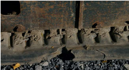
Abriss der äußeren Gummikante auf einem langen Stück
