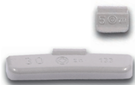
Ausgleichgewicht-Zink Typ 133, universal Universal für Stahlfelgen mit J-Horn, beschichtet – auch für Transporter geeignet – einsetzbar wie Typ 164 (MB Sprinter)
