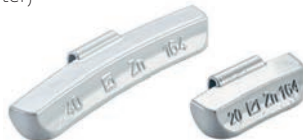
Ausgleichgewicht-Zink Typ 164 PREMIUM LINE Sowohl für Stahlfelgen französischer Fahrzeuge, als auch für Stahlfelgen von Leicht-LKW (mit größerer Materialstärke der Felge), Originalteil von MERCEDES Sprinter und VW Crafter Stahl- felgen, beschichtet
